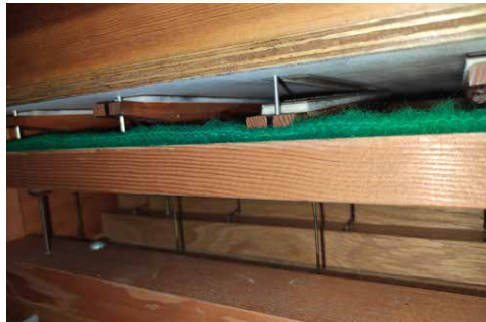
Blick in eine Windlade der Beckerath-Orgel. Im Vordergrund ein geöffnetes Ventil, durch das die Luft zu den Pfeifen gelangt.
