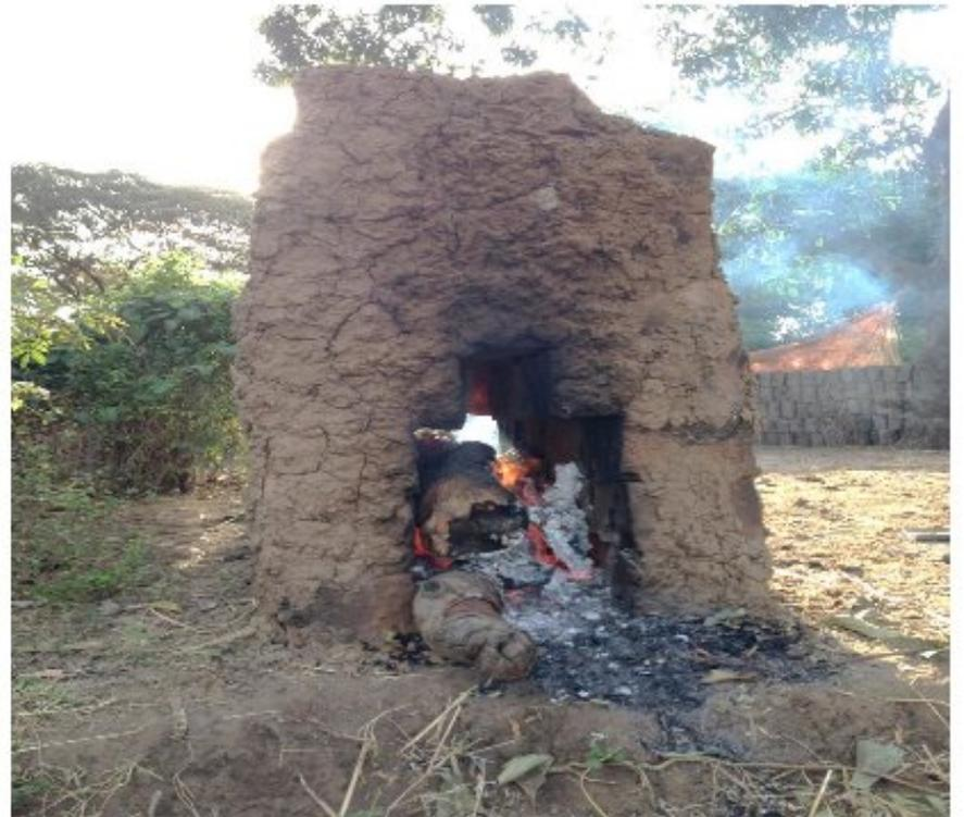
Der Lehm wird an den Ufern ausgestochen, zu Ziegeln geformt und luftgetrocknet. Aus den Rohziegeln wird ein "Häuschen" gebaut. In dessen Inneren wird ein Feuer gemacht, fertig ist der gebrannte Baustein.
